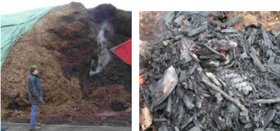
FAQ 27 Abbildung 1: Links beginnender Schwelbrand in einem Aussenlager, rechts Glutherd
